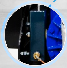
DEPOSITO DE ACEITE
